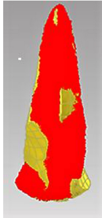
Fig. 6. Mesh Model is placed on top of the CAD Model. Fig. 6. Le modèle Mesh est placé au sommet du modèle CASH.
