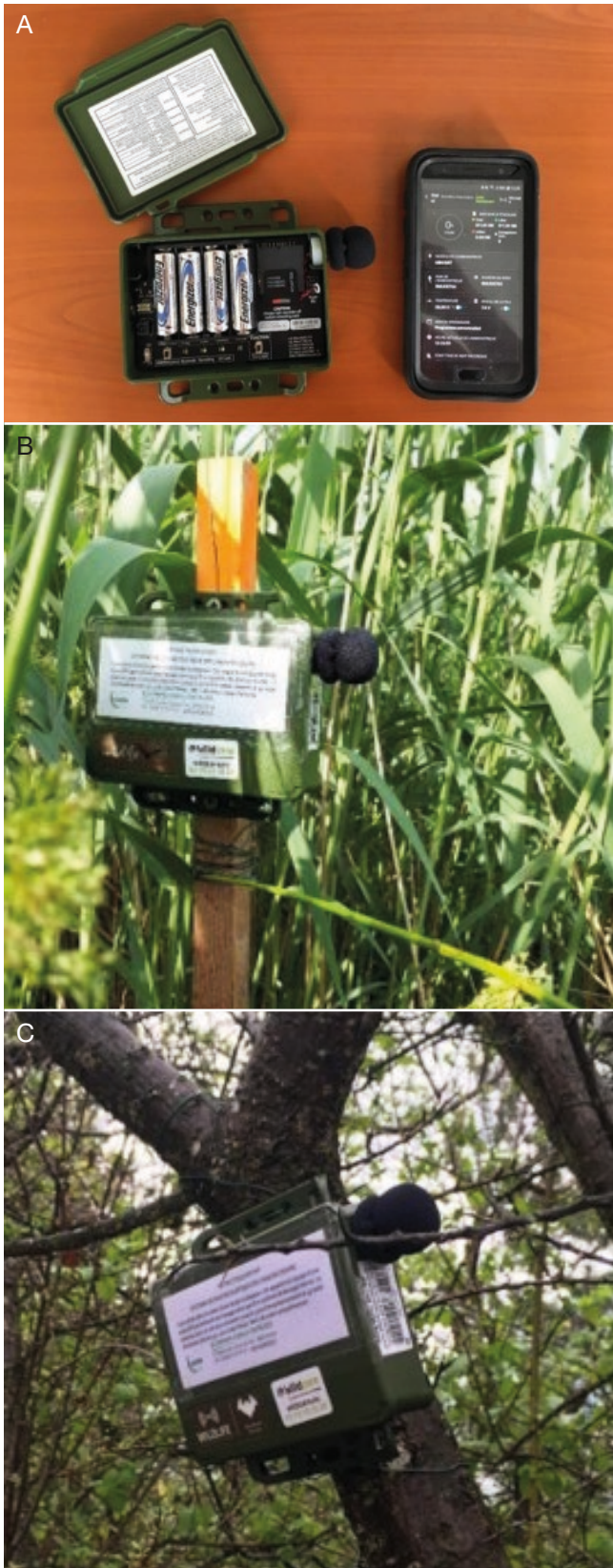
Fig. 4. — Dispositif d'enregistrement automatique Wildlife Acoustics Song Meter Mini Bat équipé d'un micro audible: A , paramétrage de l'unité via l'application Song Meter Configurator (liaison Bluetooth); B , enregistreur installé sur un support naturel (tronc d'arbre); C , enregistreur fixé sur un pieu en bois en milieu ouvert. Crédits: Valentin Monnoy (Écosphère).
